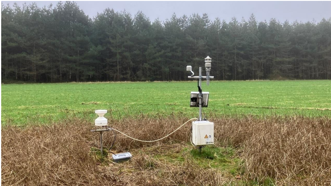
Figuur 2-3 Referentiemeetopstelling in het open veld (locatie 1). Onder de regenmeter bevindt zich een ingegraven container waar regenwater wordt opgevangen voor analyse.
